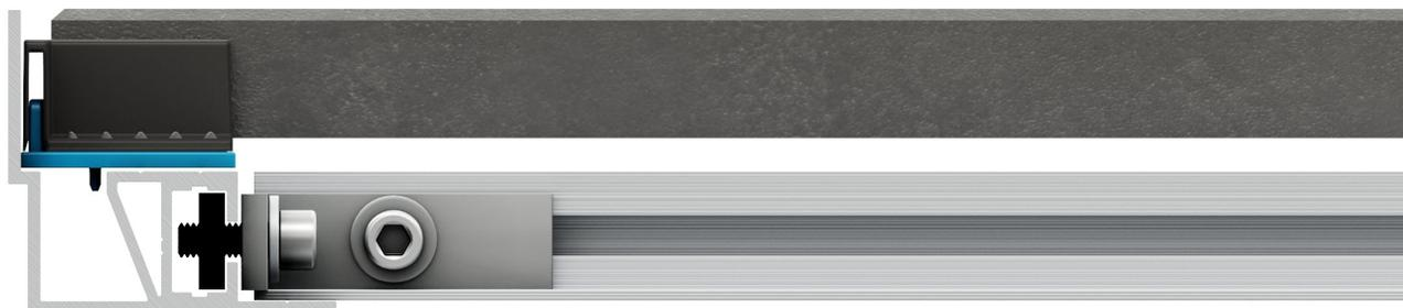
Das Randprofil Pro I Slim mit Zwischenprofil, Fugenkreuz und Keramikplatte im Querschnitt.
