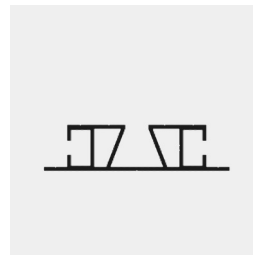
Zwischenprofil Pro Für die Verlegung von Stein- und Keramikplatten
