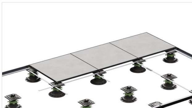
Die Platten- Auflagenpunkte werden in Längs- und Querrichtung mit einem Aluminium- Flachband miteinander verbunden.
